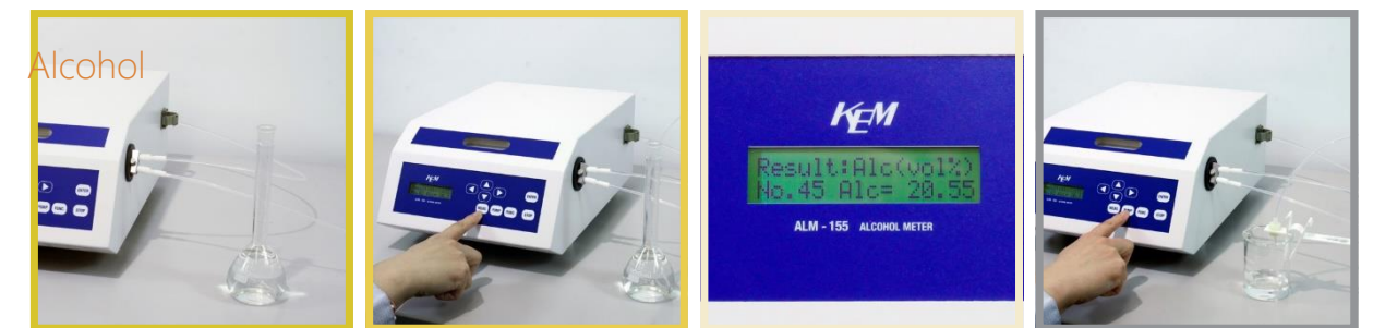
Wprowadzenie próbki do celi pomiarowej i start pomiaru
